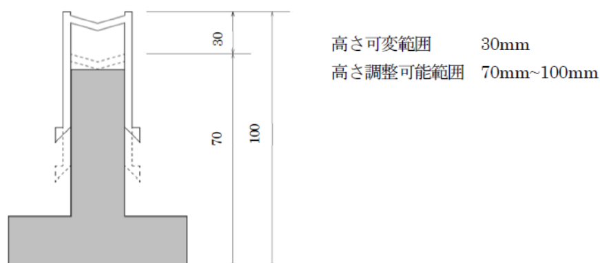
図3「高さ調節可能範囲」と「高さ可変範囲」
